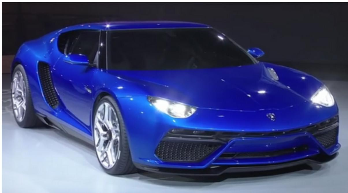
**Premier véhicule de technologie hybride rechargeable conçu par Lamborghini, le concept Asterion développe 910 ch via un V10 5.2 atmo et trois moteurs électriques. Le 0 à 100 km/h est abattu en 3 s pour des émissions de CO2 limitées à 98 g/km.**
