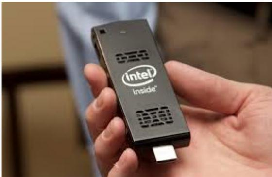
Il ressemble à **une clé HDMI, se branche sur secteur** et transforme votre téléviseur ou n'importe quel moniteur en ordinateur, . Equipé de **Windows 8.1** en standard, il a un processeur **Intel Atom QuadCore** à **1.33 GHz**, **2 Go de RAM**, une **connexion WiFi n 150 Mbits**, le **Bluetooth 4.0**, un **port USB 2.0** et un **port microSD** pour insérer une carte de stockage pour les applications.
